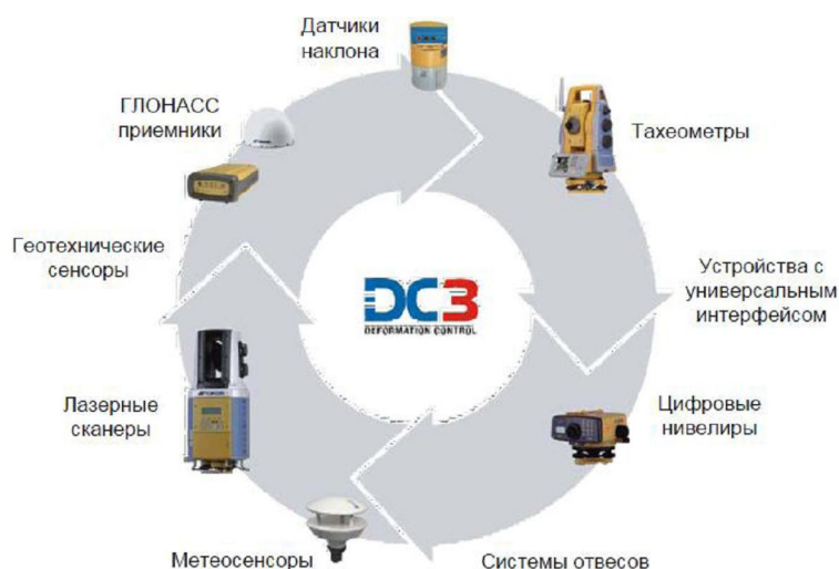
Рисунок 2 – Элементы системы DC3 (Deformation Control) наземно-космического мониторинга ГТС
