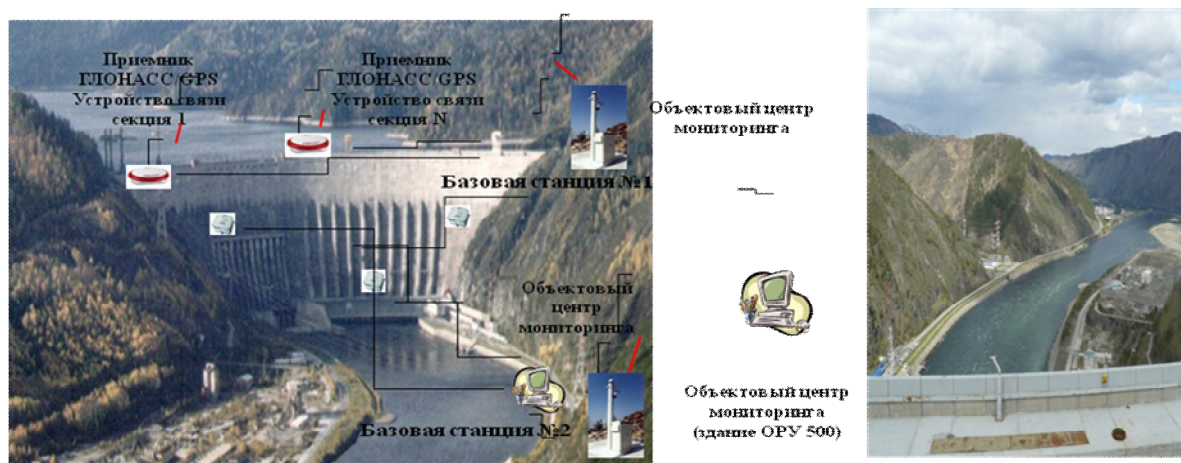
Рисунок 1 – Структурная схема наземной спутниковой системы GPS-мониторинга объекта
