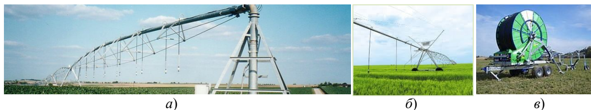
а – поливочная машина с центральным приводом (кругового действия); б – поливочная машина с фронтальной системой полива; в – поливочная машина барабанного типа с поворотной платформой
