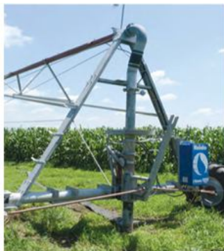
Рисунок 4 – Размещение панели управления Precision Management (RPM) фирмы Reinke на неподвижной центральной опоре
