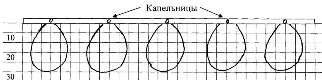
Рисунок 2 – Контурсы увлажнения при групповой работе капельниц и выдаче поливной нормы 0,8 л
