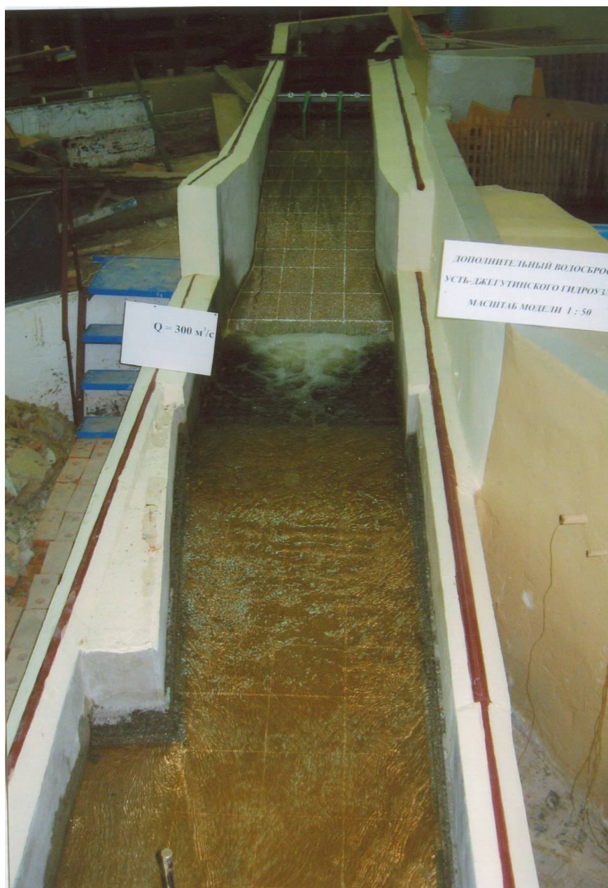
Рисунок 3 – Работа модели сооружения при Q = 300 \text{ м}^3/\text{с} , вид с НБ
