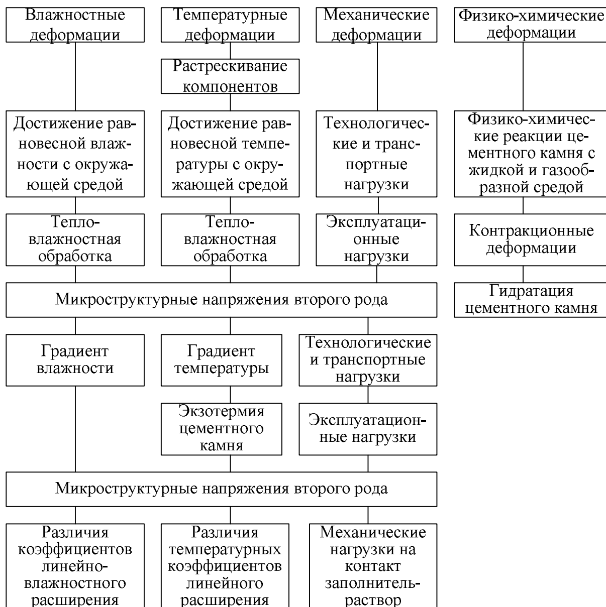
Рисунок 1 – Основные причины образования повреждений в конструкциях сооружений
