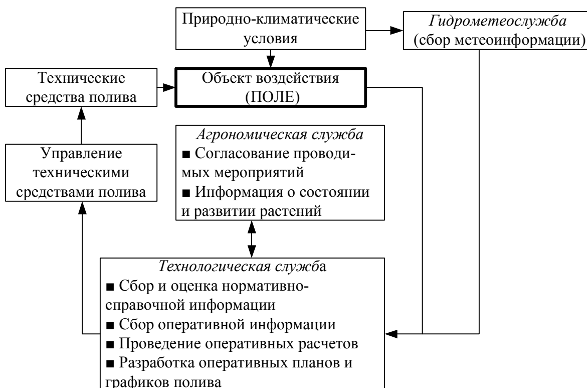
Рисунок 1 – Структурно-функциональная схема оперативного управления поливами
