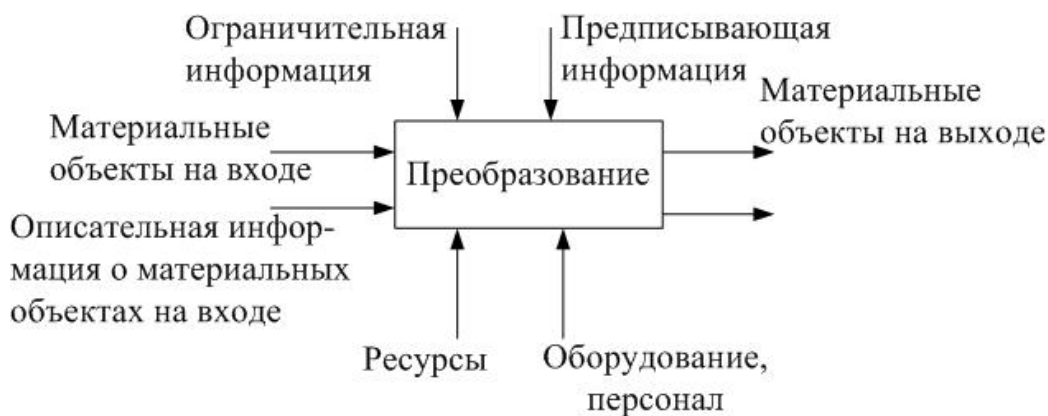
Рис. 1. Схематическое изображение связей преобразующего блока
