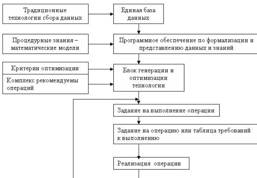
Рис. 1. Функциональная структура СППР
