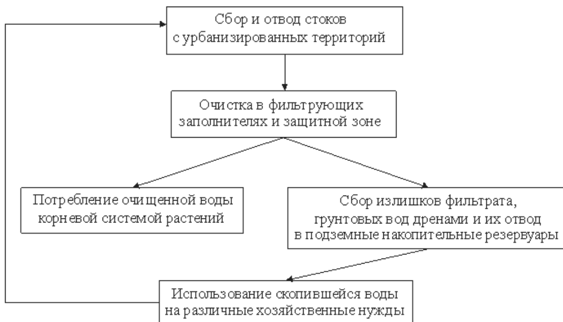
Рис. 2. Блок-схема функционирования устройства отвода и утилизации ливневого и талого стоков
