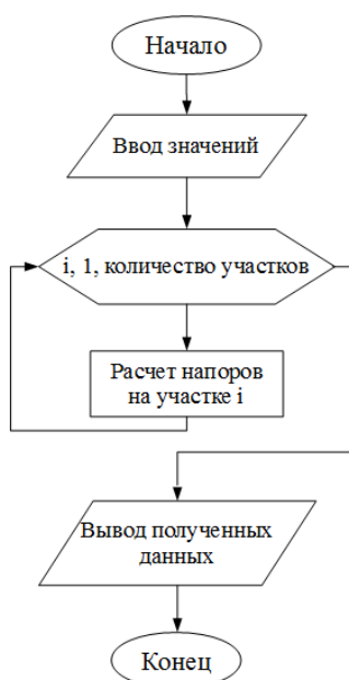
Рисунок 2 – Блок-схема алгоритма расчета гидравлических режимов водозаборной насосной станции и трубчатой закрытой оросительной сети
