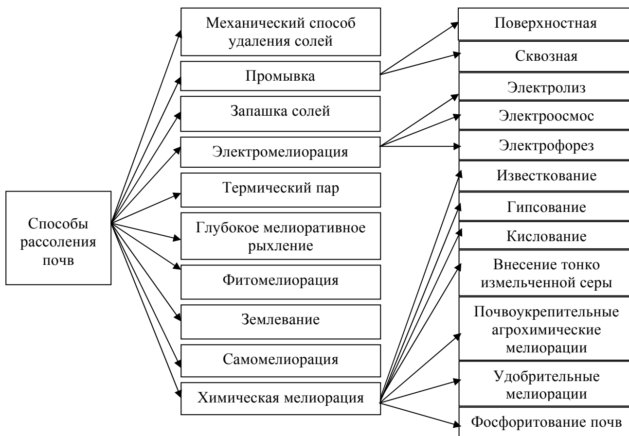
Рис. 4. Способы удаления солей из профиля засоленных почв
