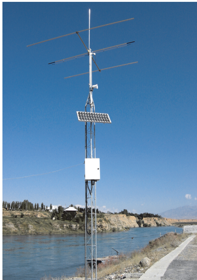
1-расм. MMC – 545B маркали метеоролог радиостанцияси
