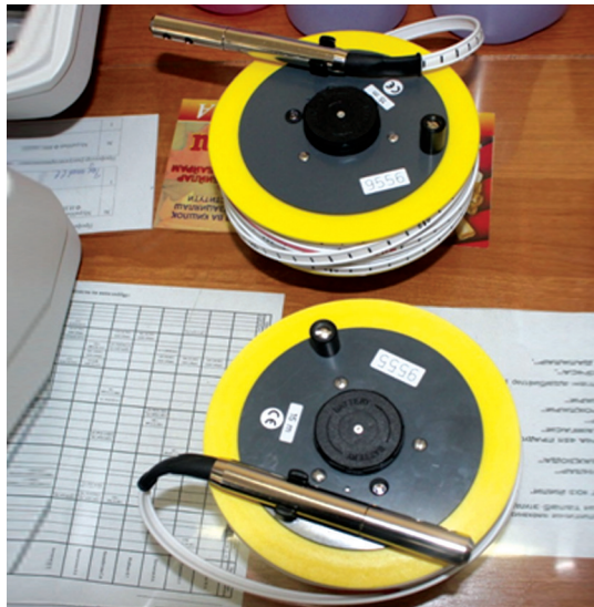
2-расм. Ер ости сизот сувлари сатҳини ўлчовчи мослама (SEBA- Kabellichtlot Typ KLL-Mini Messbereich 15 м)
