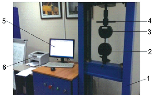
1-рама; 2-нижний захват; 3-верхний захват; 4-дисплей компьютера; 5-принтер
