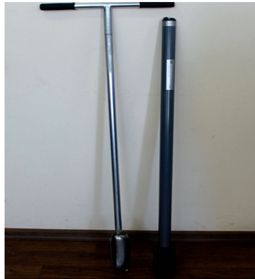
3-расм. Тупроқ намлигини аниқлаш жиҳозлари (UGT-BodenfeuchteSonde UMP-1 BT incl. ZweiVorboller)
