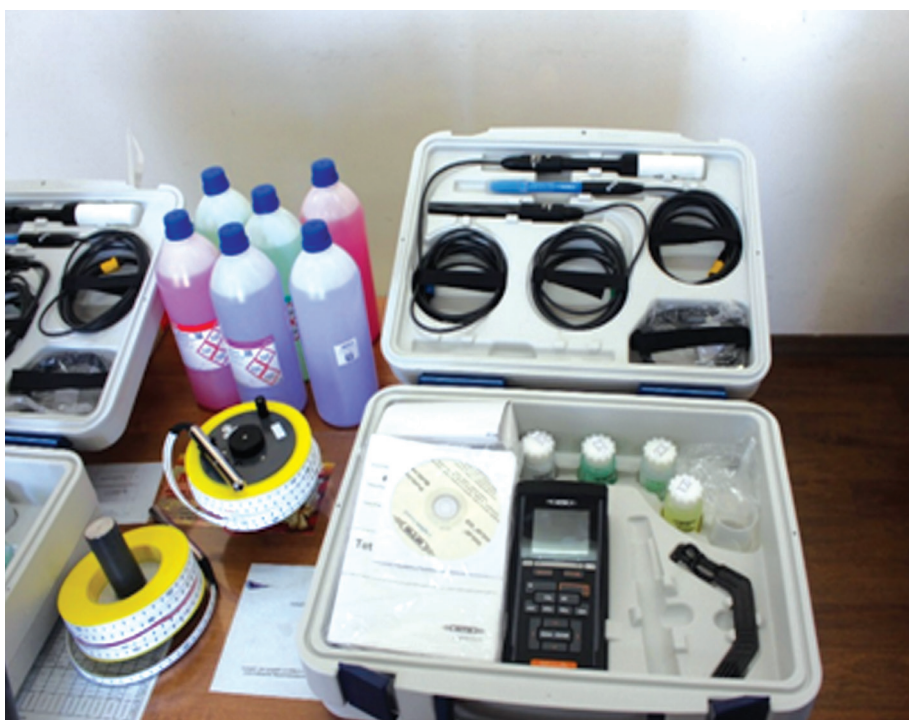
1-расм. Тупроқ ва сувнинг pH кўрсаткичи, таркибларидаги тузлар миқдорини аниқлаш учун юқори аниқликдаги, рақамли кўп параметрли лаборатория жиҳозлари (WTW Digitales Multiparametergerat, Set Multi 3620 IDS Set G)
