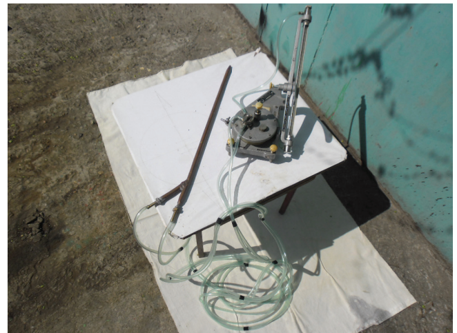
3-расм. Такимиллаштирилган найча боғланган ММН-240(5)-1,0 микроанометрининг умумий кўриниши
