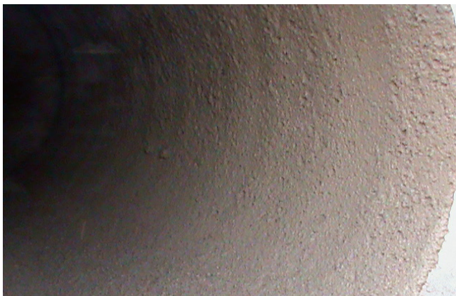
3-расм. Экспериментал изланишларда ички юзаси Kalmatron® қўшимчали торкретбетон билан 10 мм қалинликда қопланган, диаметри 1420 мм бўлган, лойиҳа параметрлари тикланган босимли қувур фрагментинг кўриниши
