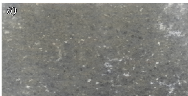
4-расм. Лаборатория изланишлари учун босимли қувурдан 20x30 см қилиб кесиб олинган намунада а-ҳосил қилган Kalmatron® қўшимчали торкретбетоннотекис сирти; б-босимли қувур занглаган металл сиртидан торкретбетон ажратилиб олинганидан кейинги ҳолати.
