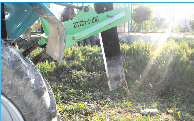
Рис.1. Экспериментальная установка для обоснования параметров дренажно-кротовых орудий в полевых условиях
