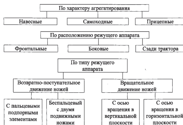
Рис. 1. Классификационная схема мелиоративных косилок
