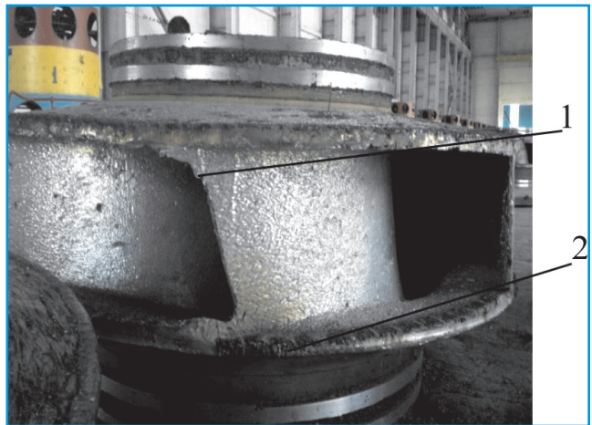
1- насос қурилмаси ишчи паррагининг синиши натижасида тўсатдан содир бўладиган бузилиши; 2-насос паррагининг ейилиши натижасида аста-секин ишдан чиқиши.
