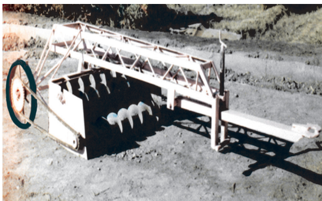
Рис. 2. Общий вид экспериментального образца мини планировщика
