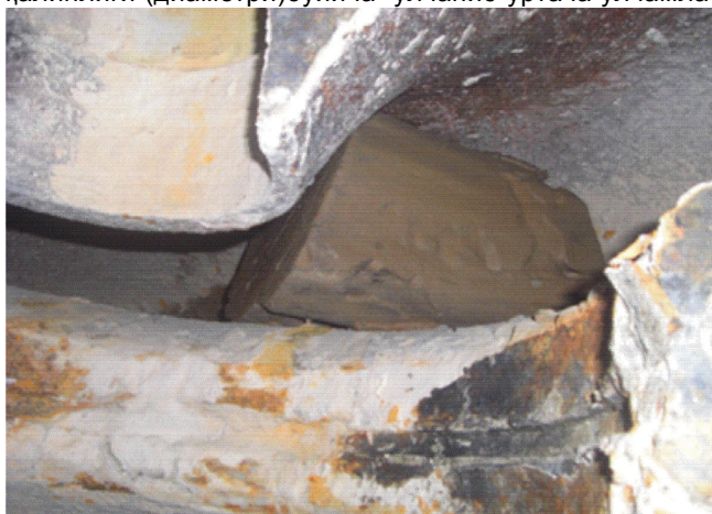
2-расм. Насос ғилофига тўнканинг кириб қолган ҳолати
