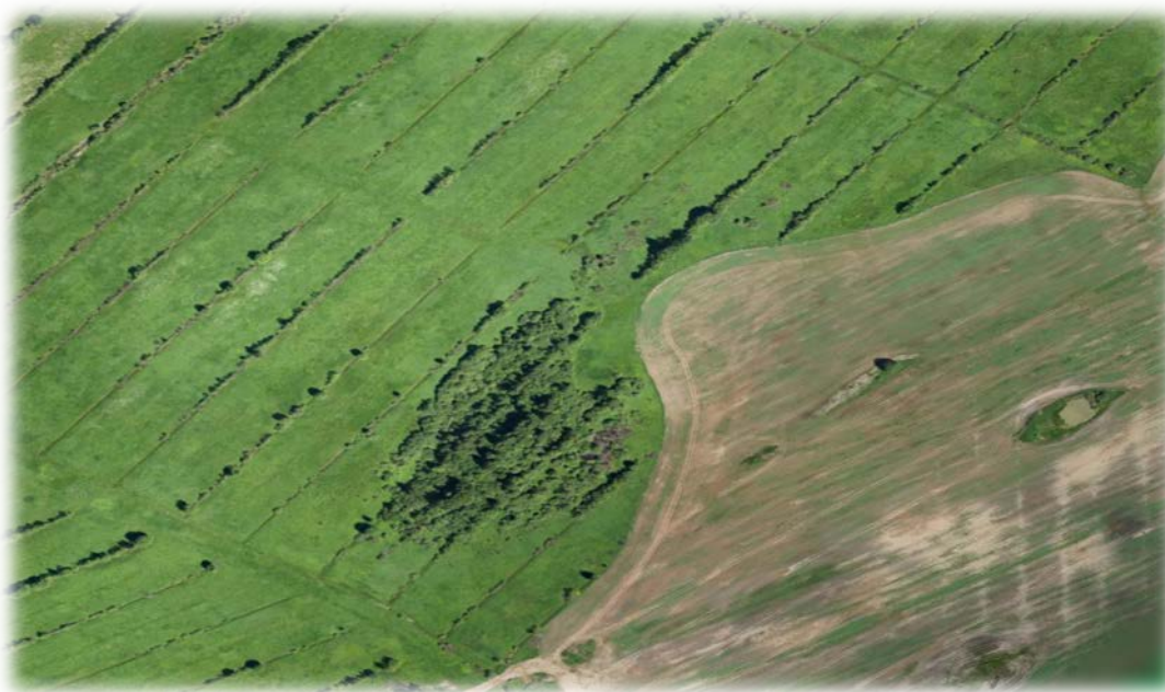
Рисунок 4 - Локальные неисправности мелиоративной системы
