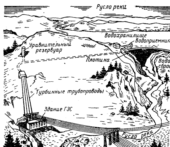
Рис. 15.5. Деривационная ГЭС с напорной деривацией.
