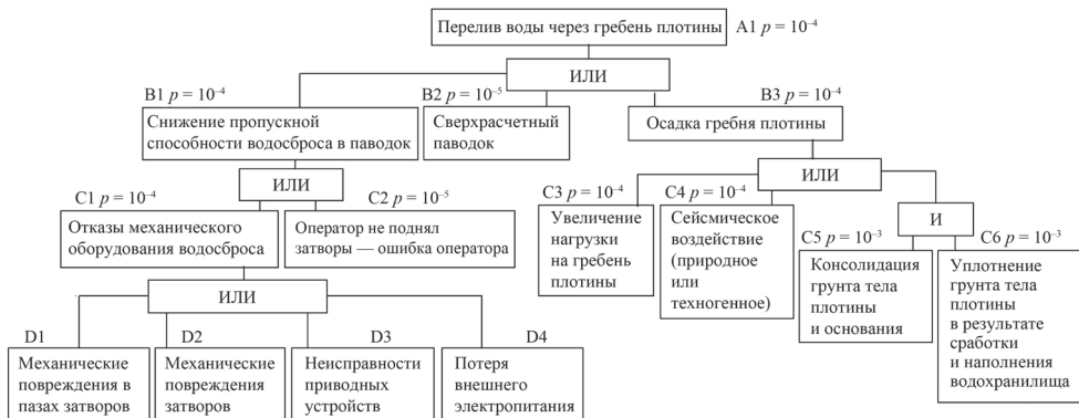
Рис. 2. Дерево отказов для сценария аварии А1 «Перелив воды через гребень плотины Чирюртских ГЭС» с учетом внесенных изменений и указанием вероятностей наступления событий
