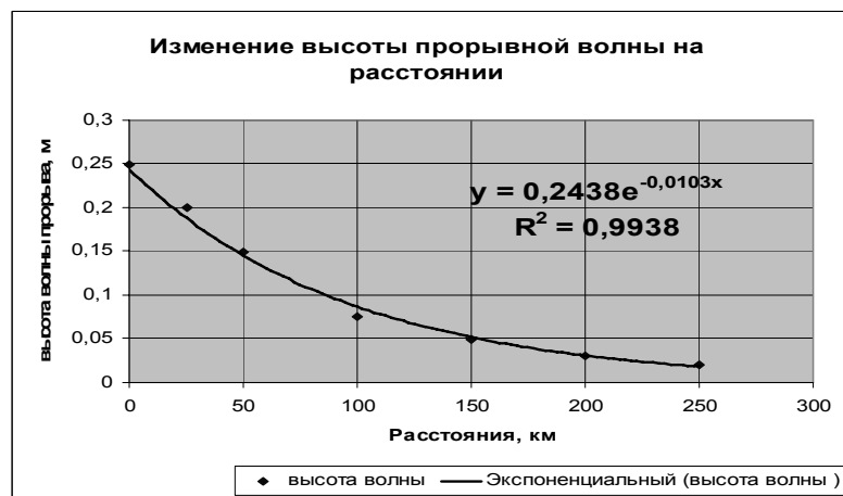
Рис. 1. Высота волны прорыва на различных расстояниях от плотины
