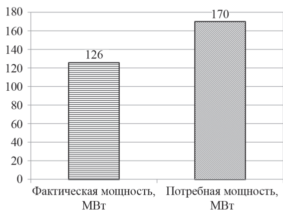
Рис. 2. Установленная мощность Кайраккумской ГЭС, фактическая и планируемая
