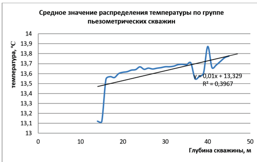
Рис. 2. Среднее значение распределения температуры по группам пьезометрических скважин
