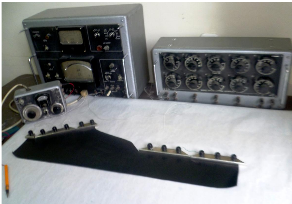
Рисунок 2.8 – Электрическая модель канала в насыпи, выполненная на электропроводной бумаге
