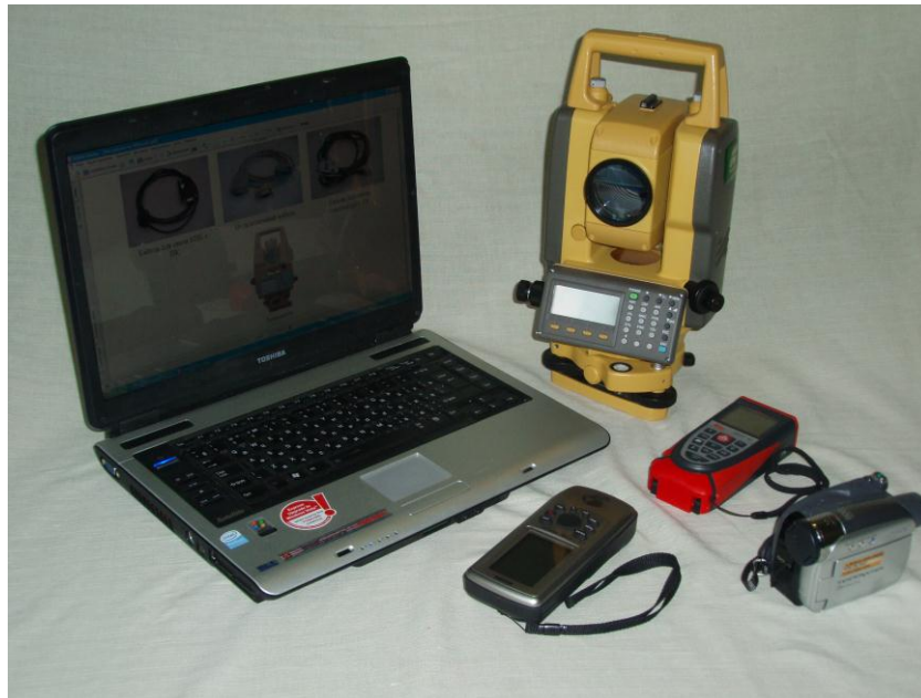
Рисунок 3.6 – Комплект оборудования для исследования основных параметров Донского и Пролетарского магистральных каналов
