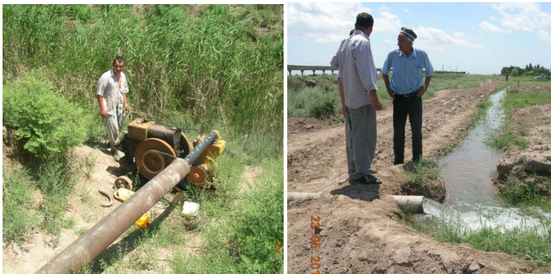
Фото 1. Отремонтированные с помощью ПМГ дизельный насос «Андижанец» для подачи воды из коллектора через систему труб в земляной ороситель дехканского хозяйства
