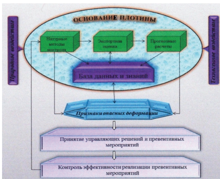
Рис. 1. Общая схема системы мониторинга основания плотины
