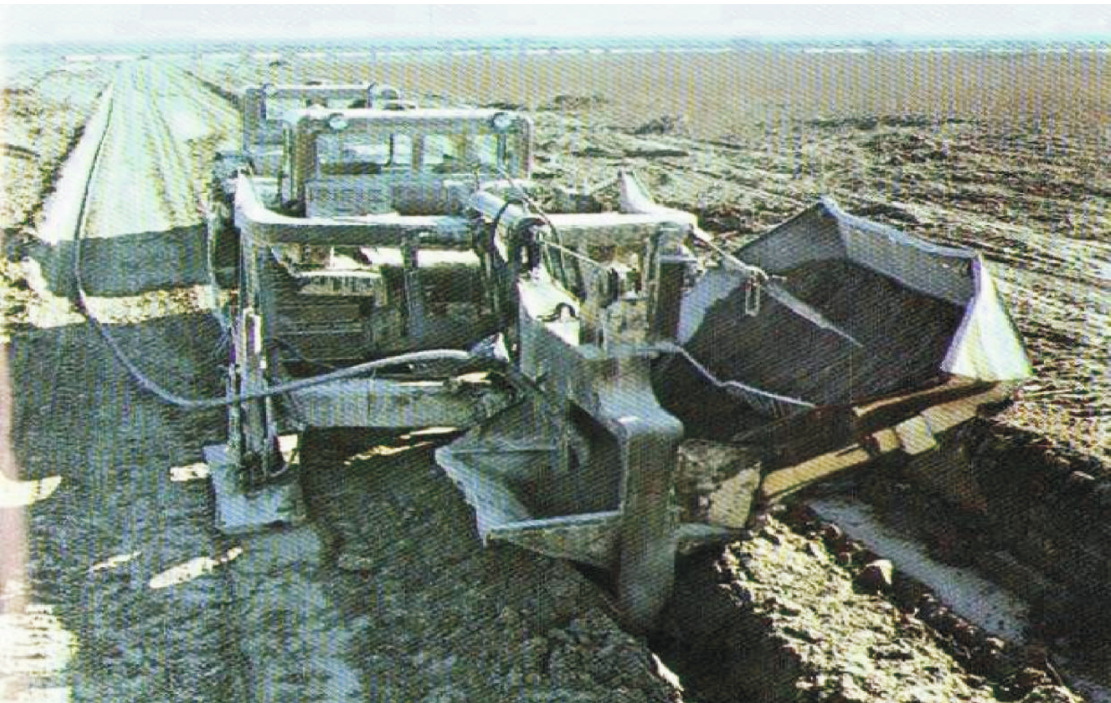
Бестраншейный дренаукладчик в Голодной степи (1970-75) The Trenchless Drainage Machine in the Golodnaya Steppe (1970-75)
