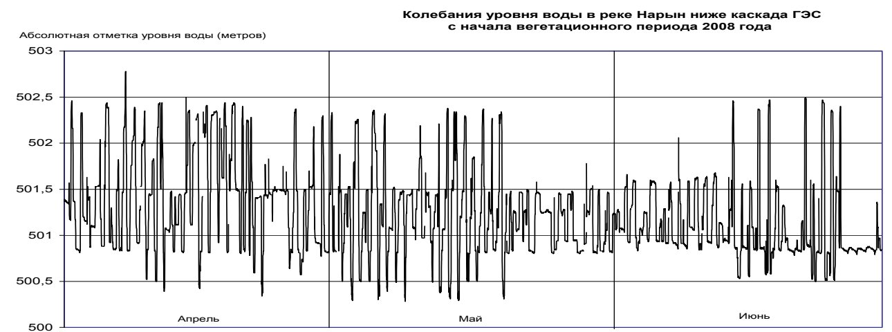
Рис. 4.17. Колебания уровня воды в реке Нарын ниже каскада ГЭС в начале вегетационного периода с 2008 года (НИЦ МКВК)
