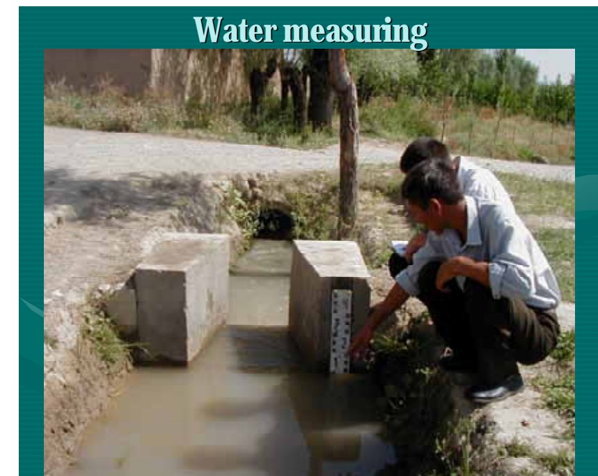
Рис. 4.32 Водомерная рейка у водослива на канале второго порядка (НИЦ МКВК)
