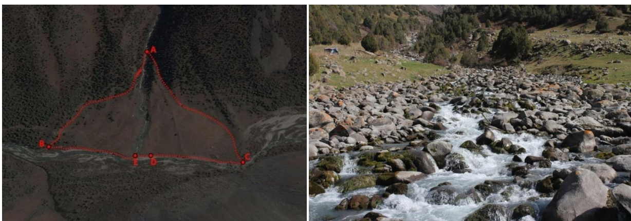
Рис.3. Конус выноса Салык. Русло реки Салык (шириной 30-40м) выполнено глыбово-каменной отмосткой, которую не могут разрушить речные паводки
