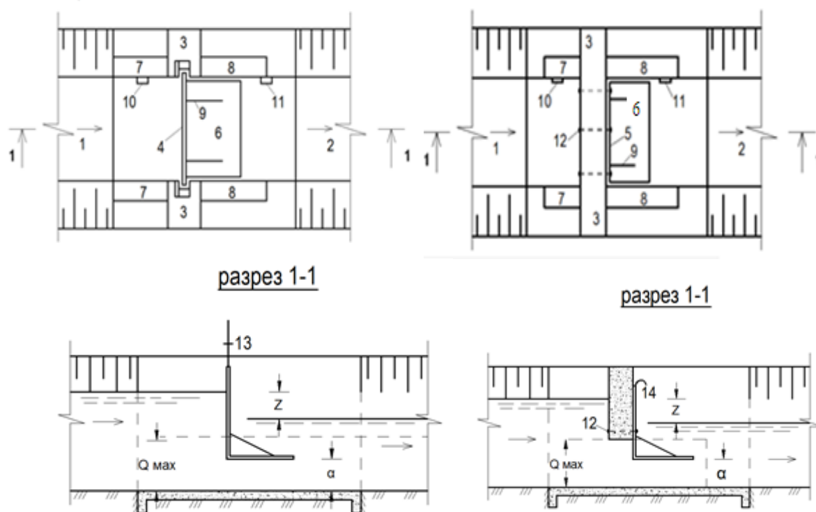
Рис 1. Схемы водомера типа «Прямоугольный насадок» для применения на внутрихозяйственных оросительных каналах с земляным руслом.
