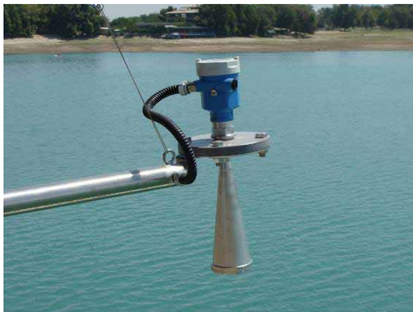
Лазерный измеритель уровня воды RDM 200C
