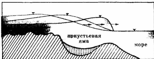
Схема образования приустьевой ямы.
