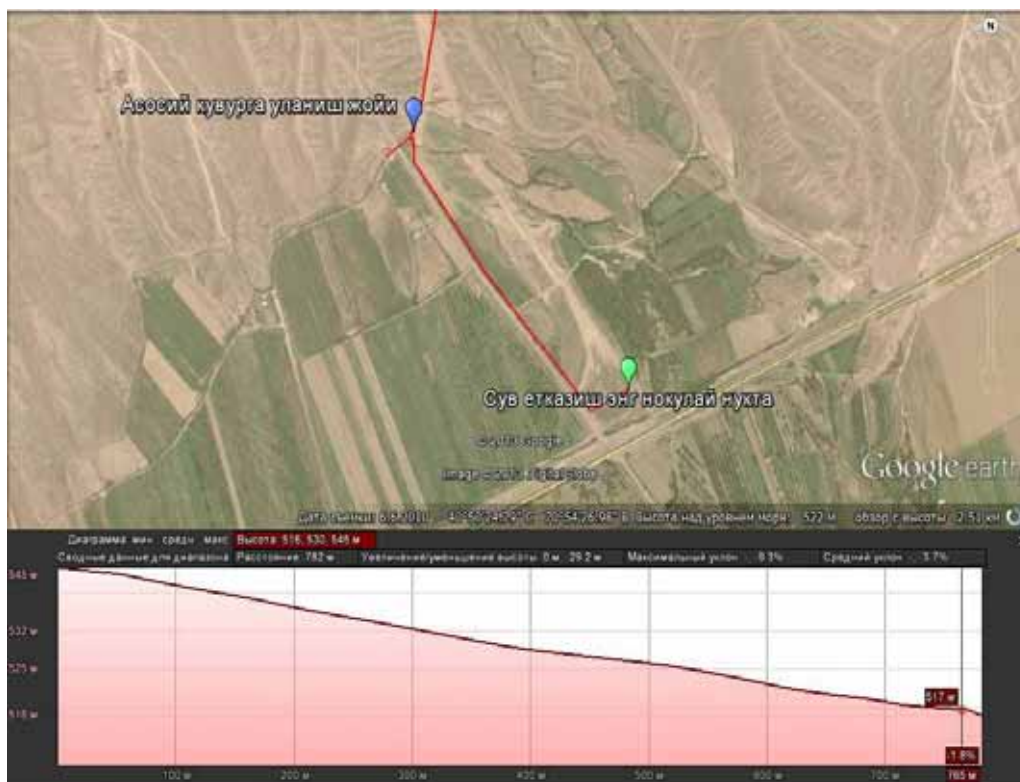
2 расм – Асосий кувурга уланиш жойи ва даланинг сув етказиб бериш энг ноқулай бўлган нуқтаси оралиғида ер юзаси абсолют сатҳининг ўзгариши
