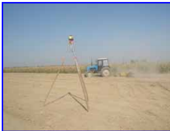
1 расм - ТТЗ-80.10 тракторига ўрнатилган лазер ускунаси ёрдамида кичик ер текислагич билан ер текислаш жараёни
