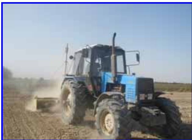
1 расм - ТТЗ-80.10 тракторига ўрнатилган лазер ускунаси ёрдамида кичик ер текислагич билан ер текислаш жараёни
