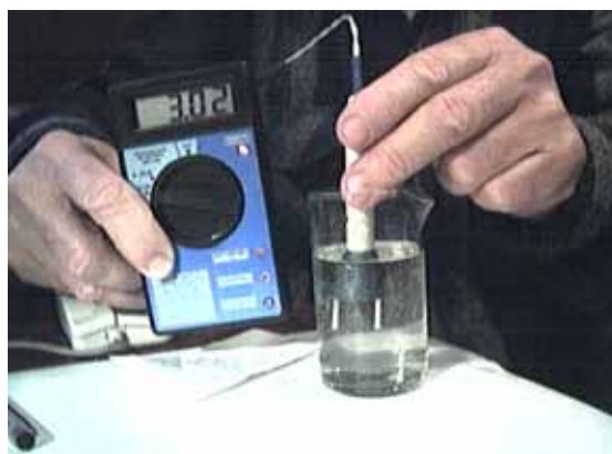
Рис 1 - Кондуктометр «ИКС-Экспресс Т». Справа - общий вид, слева – измерение
