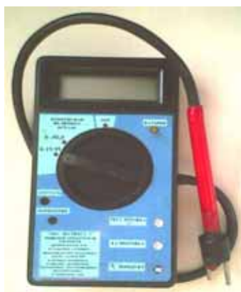
Рис 1 - Кондуктометр «ИКС-Экспресс Т». Справа - общий вид, слева – измерение
