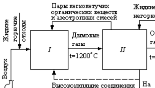
Рис. 7.4. Принципиальная схема установки термического обезвреживания ПО
