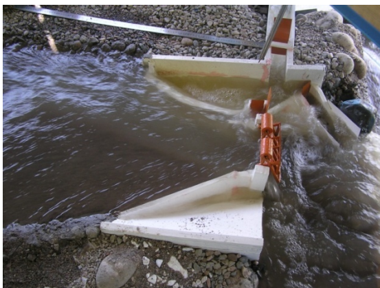
Рис. 4. Модель и строящееся водозаборное сооружение для деривационных ГЭС на р.Исык-Ата (патент КР №607, 2003; Н.П. Лавров, Г.И. Логинов, М.К. Торопов).
