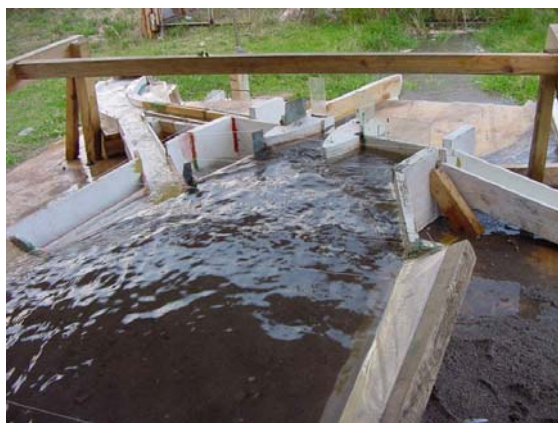
Рис. 3. Модель и натурный вариант бокового водозаборного сооружения на р. Куршаб (патент КР №586, 2003; Н.П. Лавров, А.И. Рохман, В.А. Биленко и др.).
