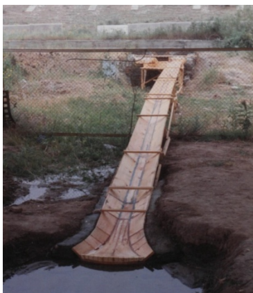
Рис. 7. Модель и построенная конструкция Орто-Токойского поверхностного катастрофического водосброса с устройством предупреждения волнообразования (А. свид. СССР №1821516; Н.П. Лавров).
