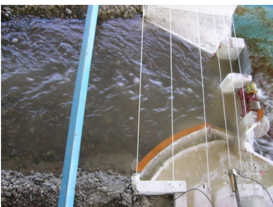
Рис. 5. Исследования и внедрение устройства рыбозащиты при водозаборе (патент КР №919, 2006; Н.П. Лавров, Н.В. Коржавин, Г.И. Логинов).
