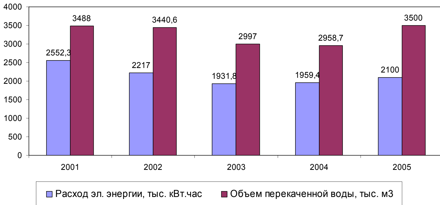
Рис. 4.1. Объем перекаченной воды и расход электроэнергии по насосным станциям ААБК
