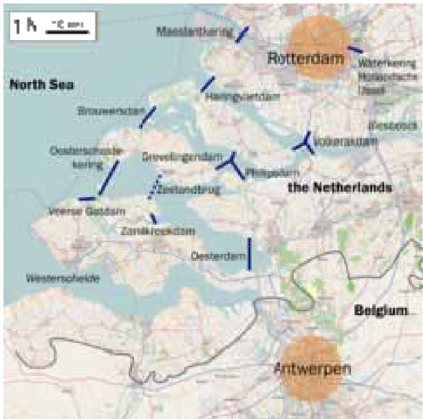
Карта дельты Рейна и проекта «Дельта». Отрезками отмечены защитные сооружения, кружками — города Роттердам и Антверпен
