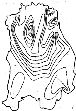
Рис. 8. Схема поверхностных течений Ладожского озера (27—30 июня 1960 г., по А. Н. Охлопковой)
