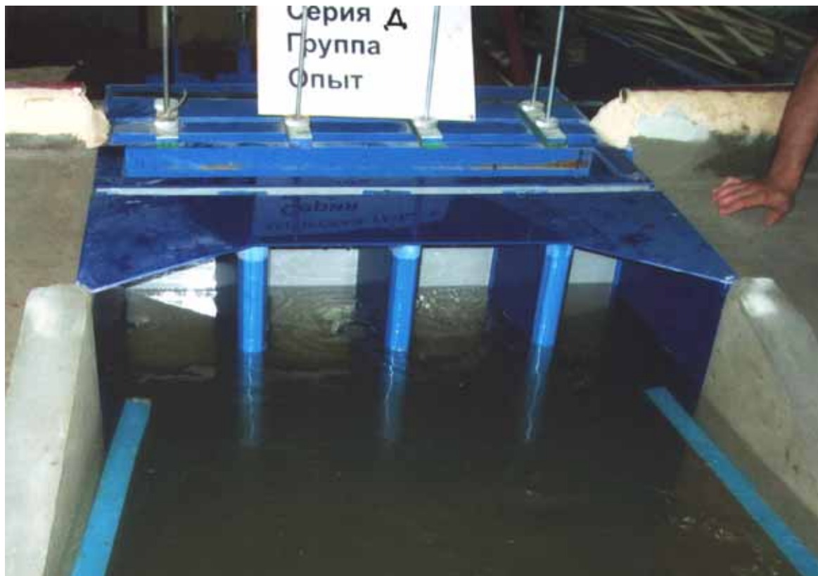
Рис. 7. Работа водоприемника и входного оголовка после реконструкции (натурный расход 944 м 3 /с). Поверхность потока спокойная
