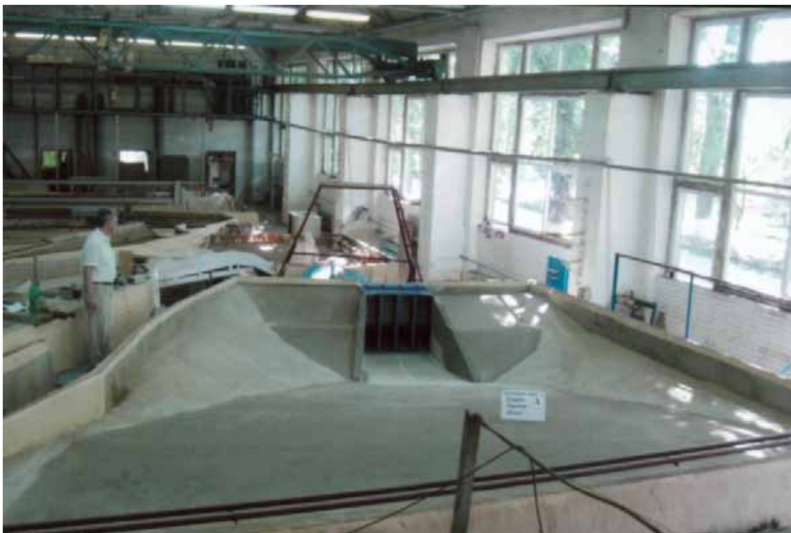
Рис. 6. Фотография модели водоприемника ГАЭС-2 после реконструкции
