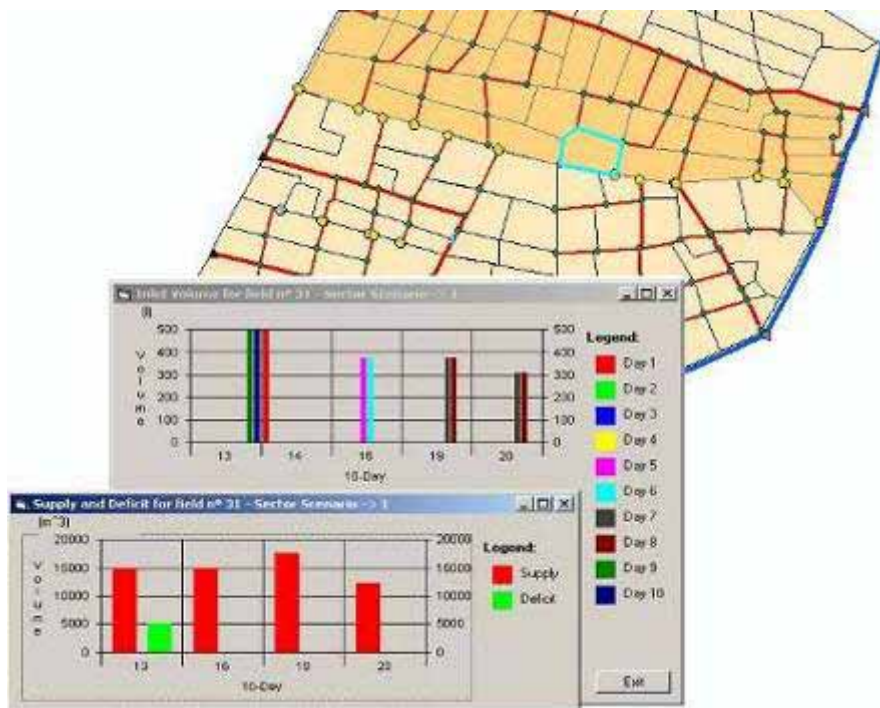
Рис. 9. Графические результаты гидрографа суточной водоподачи, расчетная водоподача и дефицит водоподачи для поля 31 по сценарию В1
