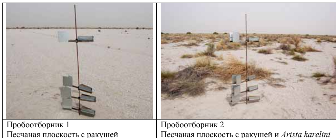
Рис. 51 Расположение двух батометров типа BSNE для оценки воздействия селина
