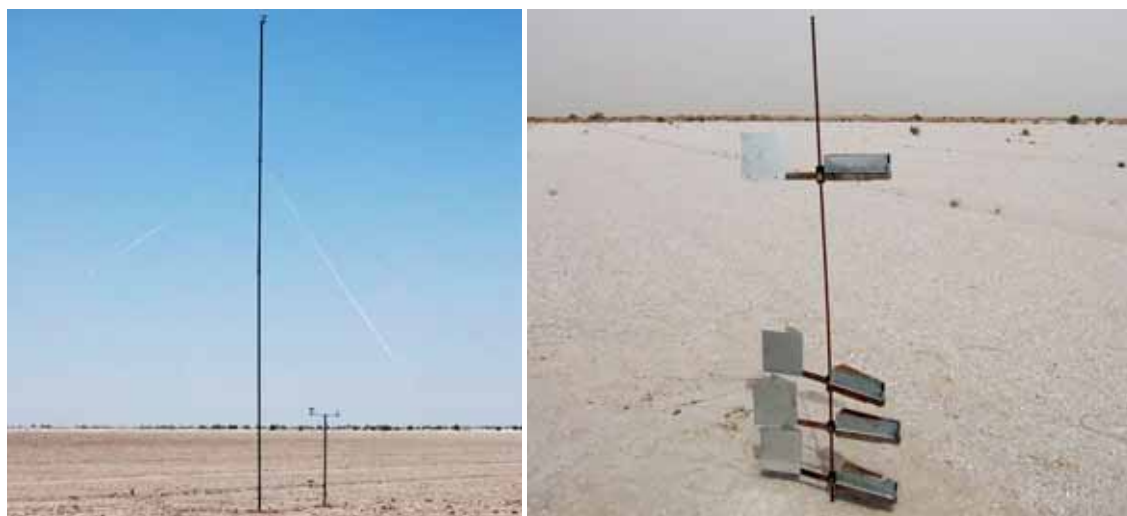
Рис. 12 Станции измерения ветра и эрозии
