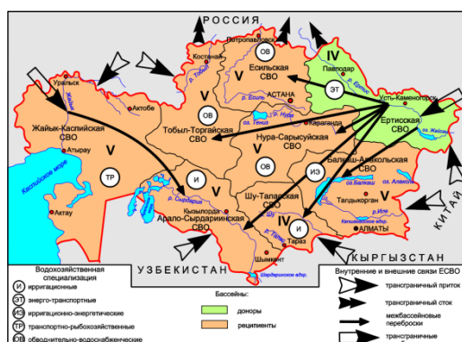
Рисунок 14 – Основные направления межбассейновых и трансграничных перебросок речного стока
