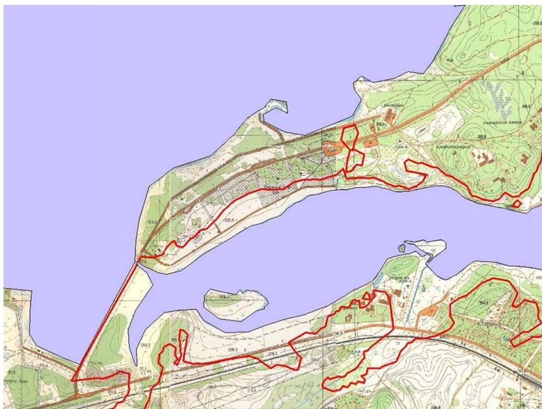
Рисунок 3 – Пример оценки зон вероятного затопления при возможном прорыве плотины (границы затопления показаны красным цветом)
