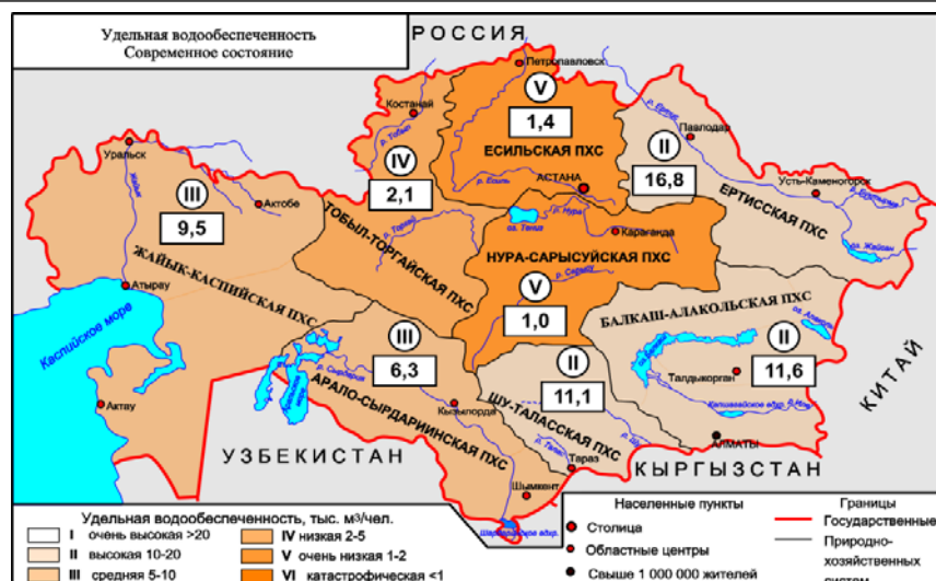
Рисунок 2 – Схема водообеспеченности Республики Казахстан [1]
