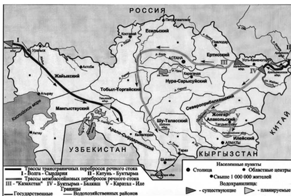
Рисунок 1 – Трассы трансграничных и межбассейновых перебросок речного стока [2] (специальное содержание разработано И. М. Мальковским, Л. С. Толеубаевой)
