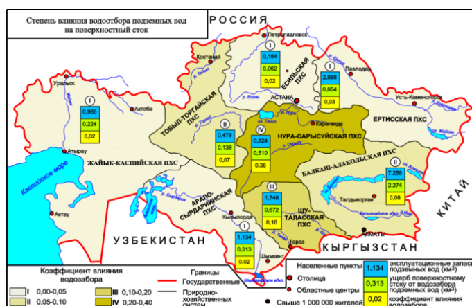
Рисунок 10 – Влияние водоотбора подземных вод на поверхностный сток
