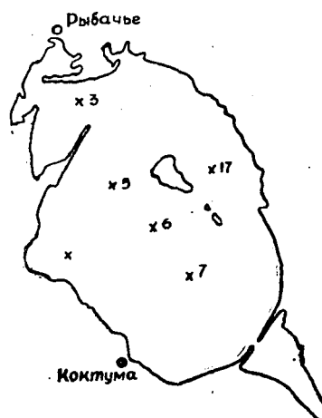
Рис. 1. Схема расположения максимально-минимальных волномерных вех на оз. Алаколь (1962—1963 гг.).
