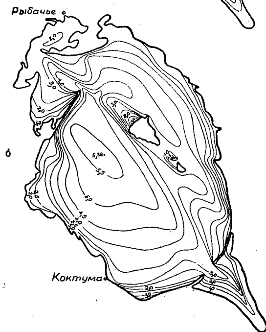
Рис. 6. Картограмма волнения на оз. Алаколь (высота волн в м) для ветра юго-восточного направления: а — при скорости ветра 20 м/сек, б — при скорости ветра 30 м/сек.
