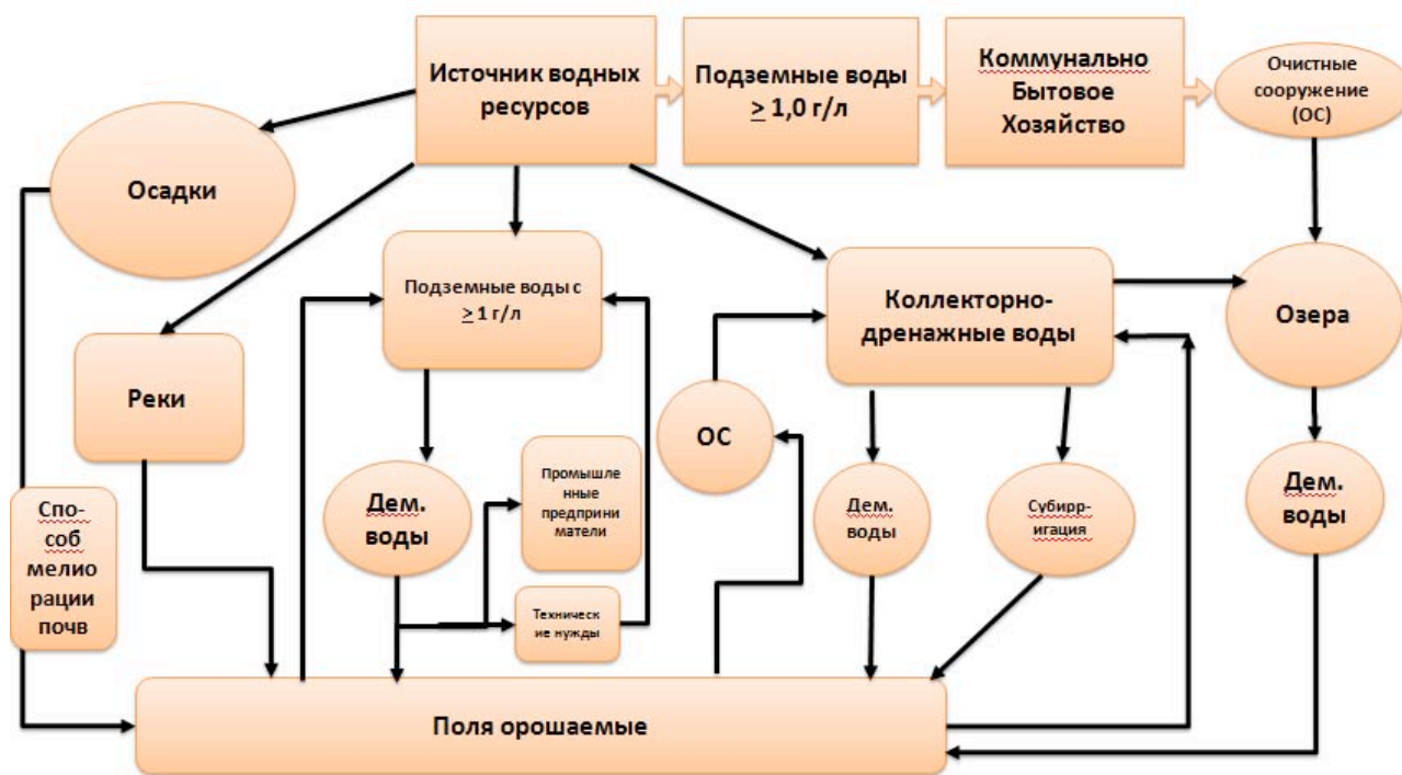
Рис. 1. Усовершенствованная схема комплексного использования и охраны водных ресурсов в сельскохозяйственном секторе экономики.
