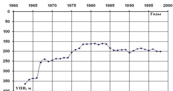
Рис. 1. Изменение среднего уровня подземных вод орошаемой зоны Каракалпакстана (данные Гидромелиоративной экспедиции Минсельводхоза Республики Каракалпакстан).
