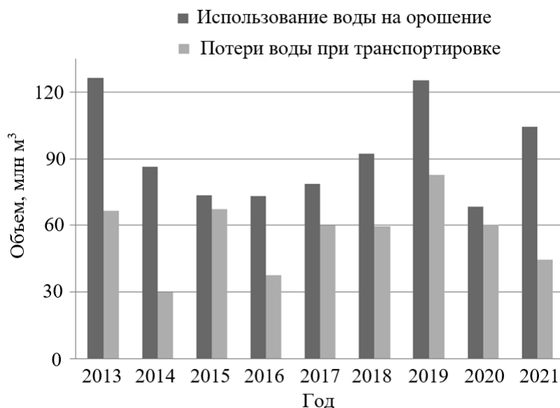
Рисунок 3 – Динамика объемов забора воды для нужд орошения и потерь при транспортировке Figure 3 – Dynamics of water withdrawal for irrigation needs and losses during transportation
