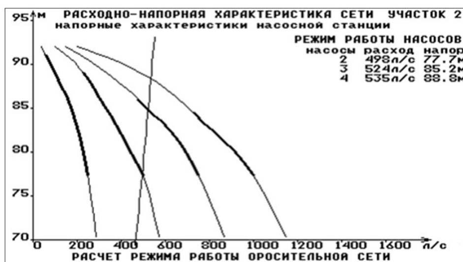
Рисунок 2 – Сопряжение напорно-расходных характеристик оросительной сети и насосной станции
