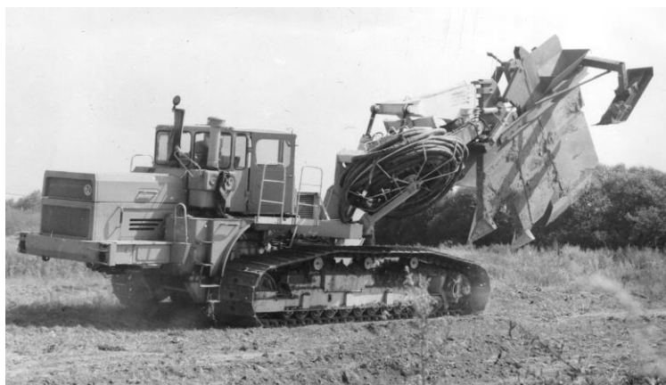
Рисунок 2 – Дреноукладчик с рабочим органом РД-3,0 (фото Е. И. Копьева)
