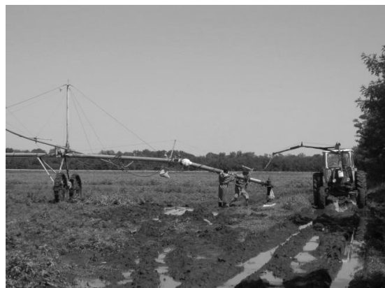
Рисунок 1 – Дождевальная машина ДФ-120 «Днепр» (автор фото Ю. Ф. Снопич)
