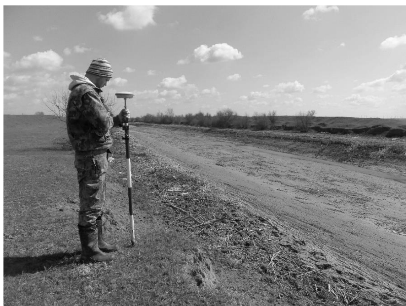
Рисунок 6 – Спутниковое оборудование (GNSS) Leica CS10 3.5G
