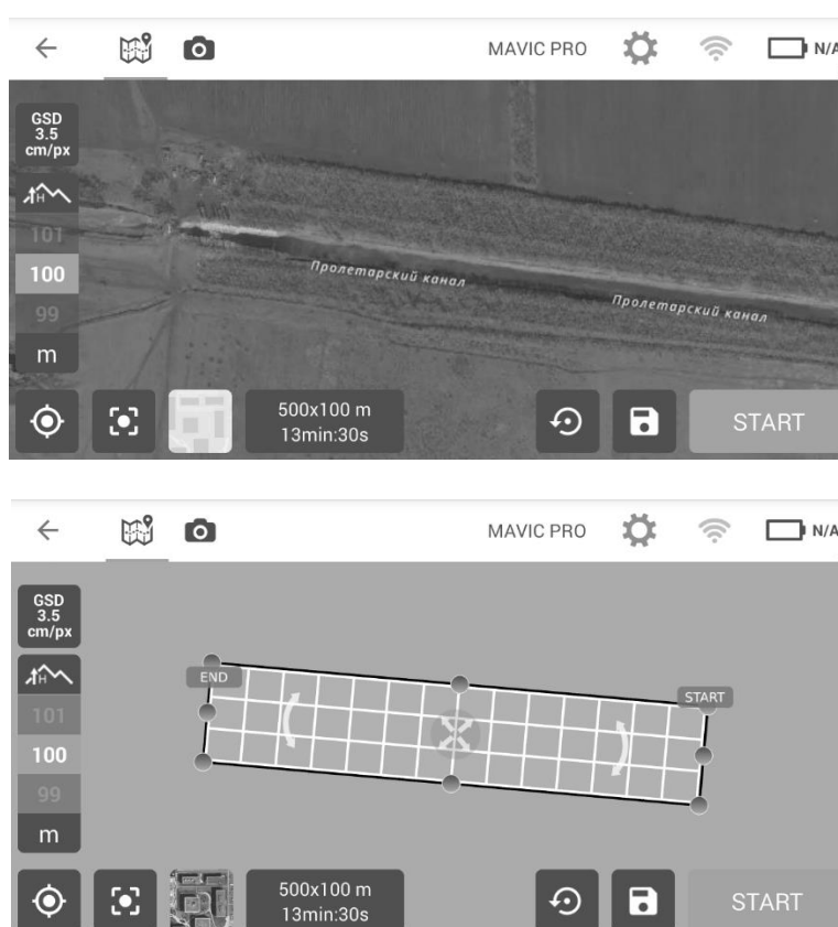
Рисунок 4 – Интерфейс определения параметров полета дрона в приложении Pix4Dcapture
