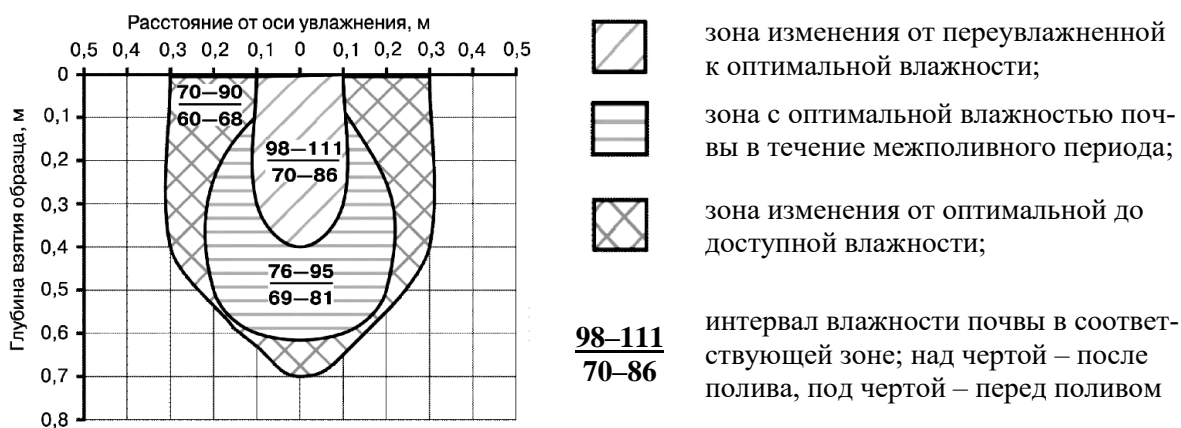
Рисунок 3 – Форма «типичного» контура увлажнения для тяжелосуглинистых почв по А. В. Шуравилину, В. В. Бородычеву и др. (2009 г.) с иллюстрацией внутриконтурного распределения влажности [6]
