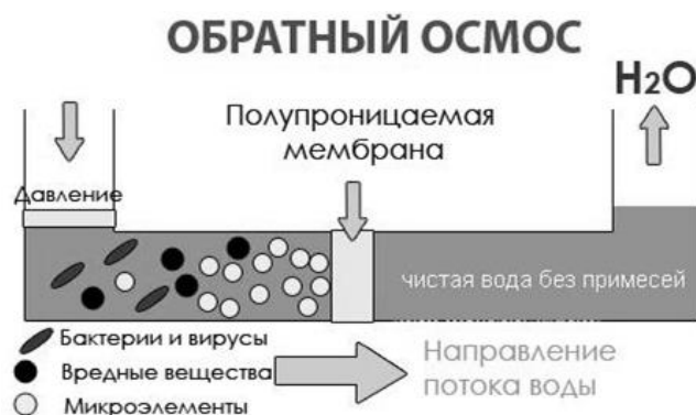
Рисунок 2 – Схема очистки воды методом обратного осмоса
