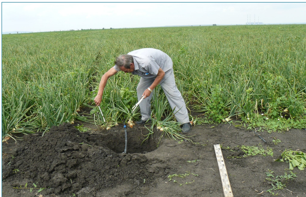
Рисунок 2 – Определение диаметра увлажненного контура и температур почвы на различных глубинах (автор фото Н. Ю. Черничкина)
