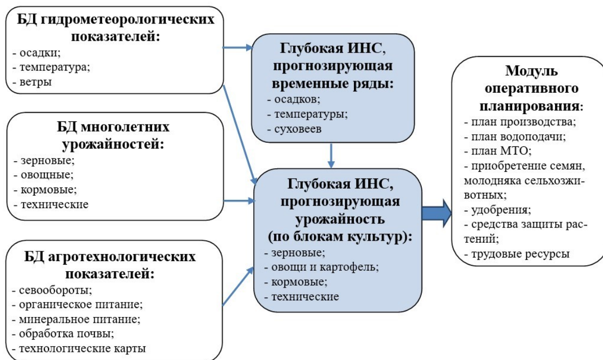
Рисунок 4 – Схема разработки плана водоподачи и агропроизводства на основе прогнозирования урожайности с использованием глубоких интеллектуальных нейронных сетей
