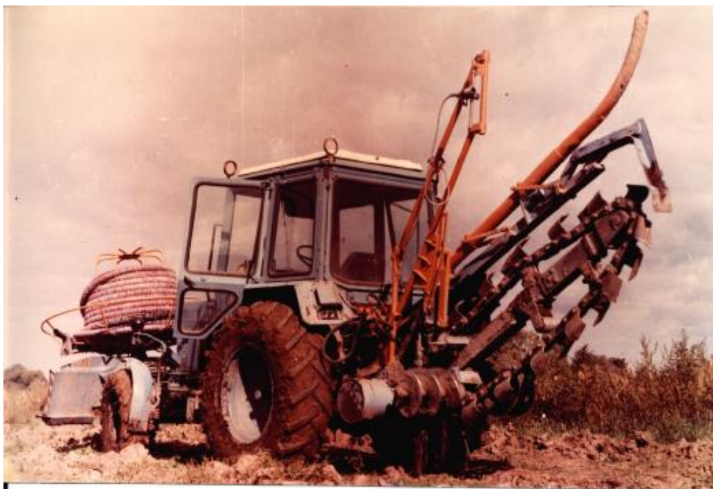
Рисунок 1 - Узкотраншейный дренаукладчик ЭТЦ-1607
