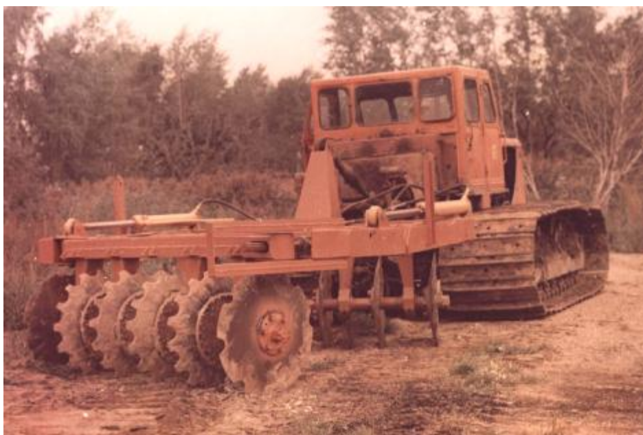
Рисунок 3 - Тяжелая дисковая борона БМН-2,5
