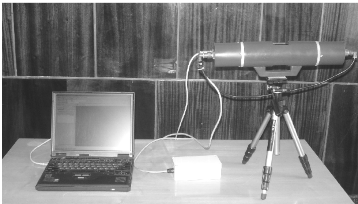
Рисунок 2 - Портативная измерительно-информационная система "Спектр-4"
