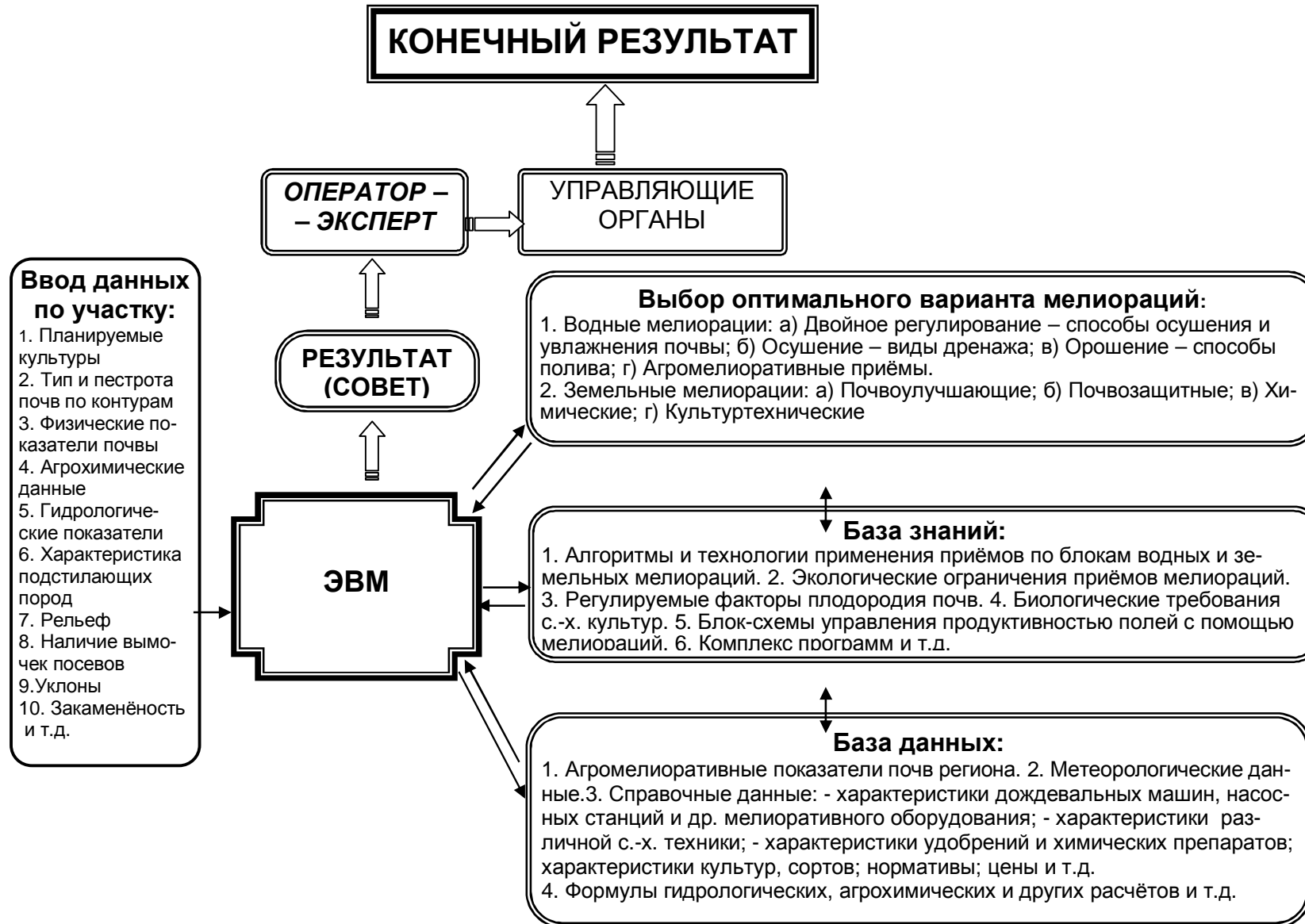
Рисунок 1 - Схема ИСС управления технологиями двустороннего регулирования водного режима почв при возделывании сельскохозяйственных культур
