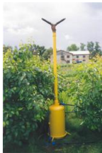
Рис.1. КСИД-1 на поливе фруктового сада: а) общий вид; б) дождеватель импульсный
